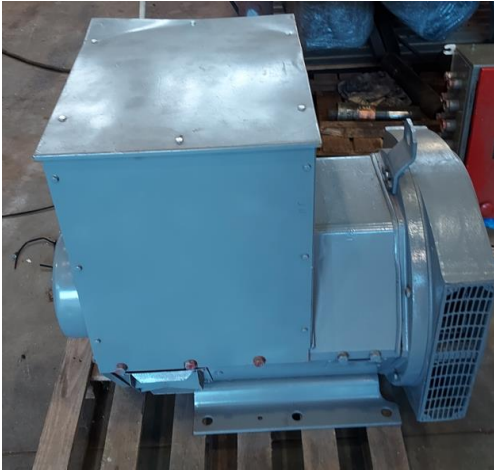
Item 309 B Stamford Generator 112 KVA, 170 AMPS
